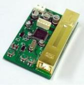
국내 최초로 상용화에 성공한 **코리아디지털(주)**의 NDIR (Non Dispersive Infrared) Dual Wavelength 방식의 CO2 가스 센서모듈은 장기 사용시 경시 변화 및 외부 온도에 의한 영향으로 측정 오차가 커지는 일반 고체전해질 방식이나 NDIR Single Wavelength 방식을 사용하지 않습니다.
