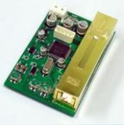
국내 최초로 상용화에 성공한 **코리아디지털**의 NDIR (Non Dispersive Infrared) Dual Wavelength 방식의 CO2 가스 센서모듈은 장기 사용시 경시 변화 및 외부 온도에 의한 영향으로 측정 오차가 커지는 일반 고체전해질 방식이나 NDIR Single Wavelength 방식을 사용하지 않습니다.
