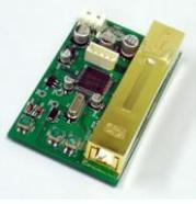
국내 최초로 상용화에 성공한 **코리아디지털**(주)의 NDIR (Non Dispersive Infrared) Dual Wavelength 방식의 CO2 가스 센서모듈은 장기 사용시 경시 변화 및 외부 온도에 의한 영향으로 측정 오차가 커지는 일반 고체전해질 방식이나 NDIR Single Wavelength 방식을 사용하지 않습니다.
