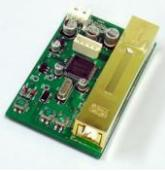
국내 최초로 상용화에 성공한 **코리아디지털**의 NDIR (Non Dispersive Infrared) Dual Wavelength 방식의 CO2 가스 센서모듈은 장기 사용시 경시 변화 및 외부 온도에 의한 영향으로 측정 오차가 커지는 일반 고체전해질 방식이나 NDIR Single Wavelength 방식을 사용하지 않습니다.
